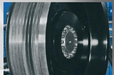
Passfedern zum Befestigen der Riemen- und Schwungscheibe. Beide Scheiben in schwerer Ausführung zur Erhöhung der kinetischen Energie.
