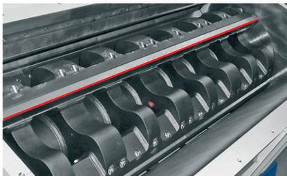
Scherschnitt Konfiguration bei 5-Blatt Rotor. Messerjustierung in Einstelllehre.
