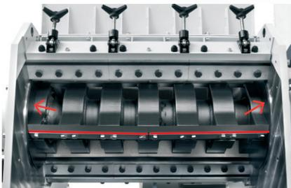
Mitlaufende Seitenscheiben und Verschleissringe; V-Rotor und Scherenschnitt bei 7-Blatt-rotor.
