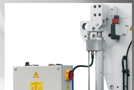
Motorische Trichteröffnung und Siebhälteröffnung mit Gasdruckzylinder.
