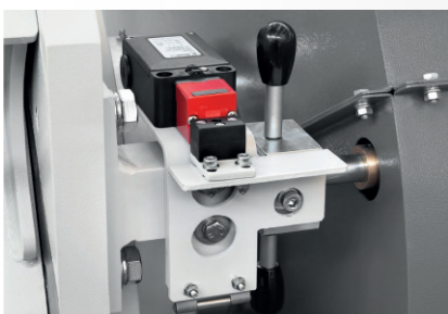
Rotorbremse zur Wartung. Sicherheitseinrichtungen und -schaltungen gemäß EU-Richtlinien.
