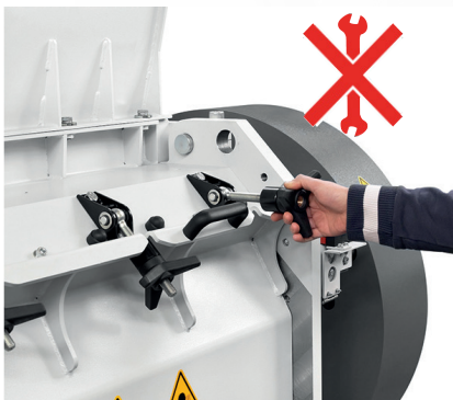
Werkzeugfreier Zugang für Wartung und Reinigung.
