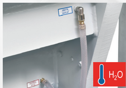
Wasserkühlung der Mahlkammer. Die Siebfläche entspricht ca. 50 % des Schneidkreis.
