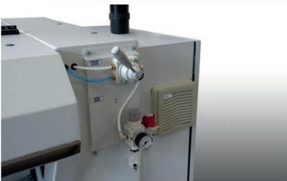
Bedienfeld zum pneumatischen Öffnen/Schließen der Rollen.
