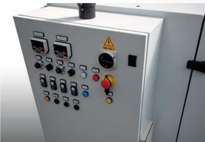
Elektrobedienfeld mit integriertem Sicherheitssystem. Betriebsart AUTO/MAN mit der Möglichkeit, das Geschwindigkeitssignal der Extrusionlinie zu synchronisieren.
