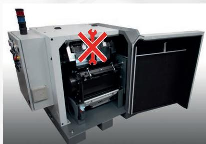
Zugang bei der Routine-Wartung ohne Werkzeuge möglich.
