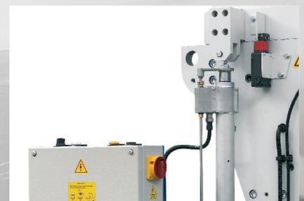
Öffnen des Trichters erfolgt mit motorgetriebener Hebevorrichtung. Öffnen des Siebhalters erfolgt über Gasdruckzylinder.
