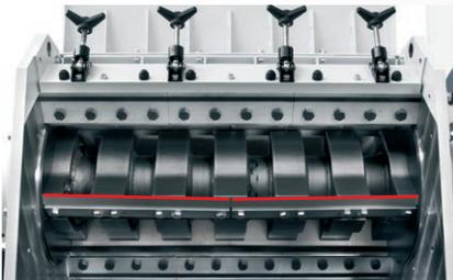
V-Rotorkonfiguration bei Rotor mit 3 und 5 Messern. Einstellung der rotierenden und feststehenden Messer in der Einstelllehre.
