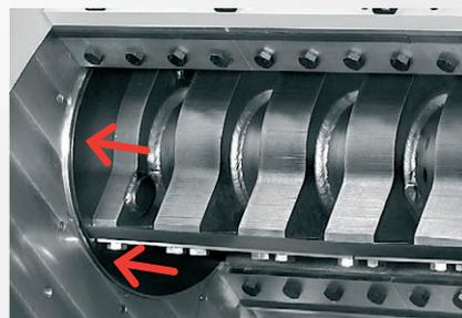
Rotor mit mitlaufenden Seitenscheiben. Wasserkühlung der Kammer
