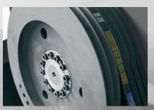
Passfedern zum Befestigen der Motorriemenscheibe und der Schwungscheibe. Große Riemenscheibe für die Übertragung der kinetischen Energie.
