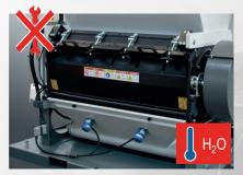
Bei Routine-Wartungsarbeiten sind die Bauteile ohne Werkzeuge zugänglich. Wasserkühlung der Kammer. Mahlkammer in verschleißfester Ausführung.
