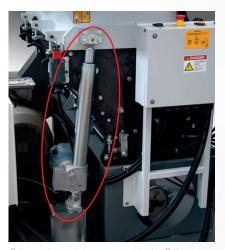
Öffnen des Trichters motorisch. Öffnen des Siebhalters erfolgt über Gasdruckzylinder. Elektrobedienfeld montiert. Sicherheitseinrichtungen und -schaltungen gemäß EU-Richtlinien.
