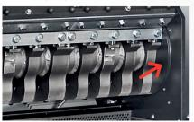
Rotor mit mitlaufenden Seitenscheiben. Einstellung Rotor-/Statormesser mit Finstelllehre.
