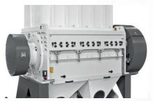
Doppelte Schwungscheibe. Spannbuchsen zum Befestigen der Riemenscheiben. Riemenscheibe und Schwungscheibe für erhöhte kinetische Energie.
