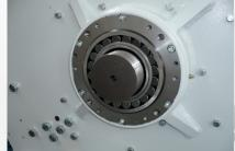
Schwenkrollenlager an der Mahlkammer montiert, Halterungen aus Grauguss.
